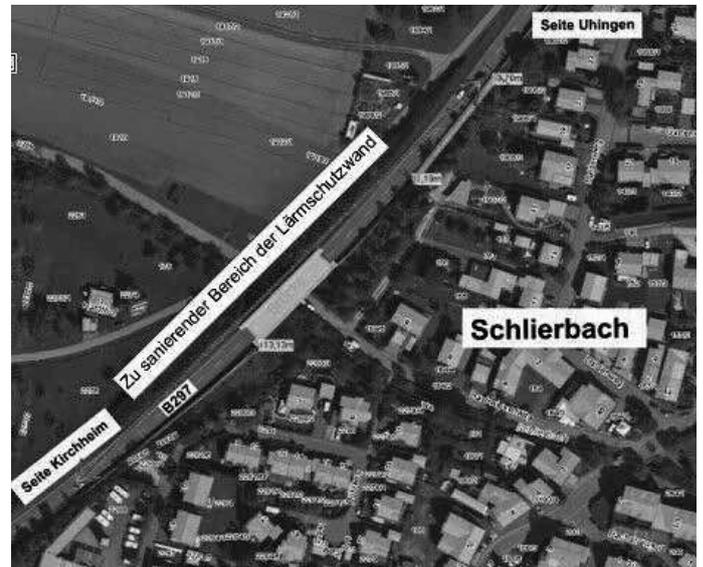
Die Lärmschutzwand, die sich teilweise in der Baulast des Bundes und teilweise in der Baulast der Gemeinde Schlierbach befindet, hatte sich im Laufe der Zeit in einigen Bereichen schief gestellt. Die schief stehenden Bereiche werden zurückgebaut und auf Bohrpfehlen neu hergestellt. Während den Bauarbeiten wird der Verkehr auf der B 297 mittels einer Ampel halbseitig am Baustellenbereich vorbeigeführt. Um die Ampelphasen zu reduzieren, wird die Sanierung in drei Bauabschnitten abgewickelt.
